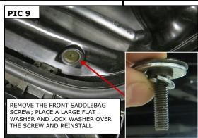
ENSURE THERE IS CLEARANCE BETWEEN THE STABILIZER BAR AND THE SCREWS ON THE UNDERSIDE OF THE SADDLEBAG
